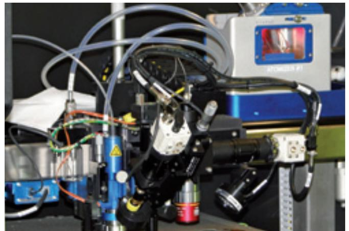
Ein Blick in die Aerosoljet-Druckanlage, bei der der Druckvorgang kontaktlos funktioniert.
